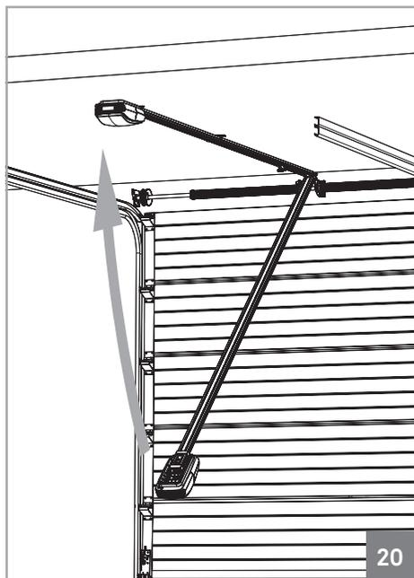
**04** • Sollevare il motore finché la guida rimane livellata orizzontalmente. Se necessario, creare una struttura di appoggio a una superficie solida come mostrato nella pagina precedente, in modo che la guida rimanga livellata (immagini 17).
