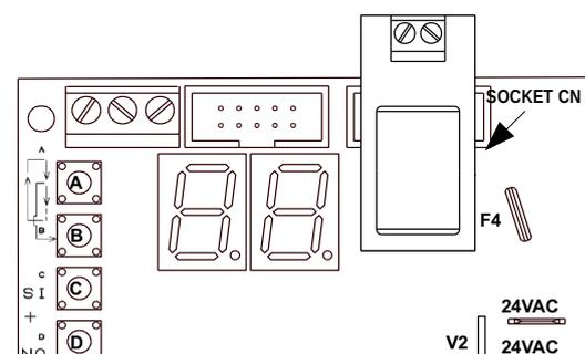
Se il modulo elettroserratura è installato impostare L0 a S1
